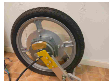
Abbildung: Vorderrad mit Radnabenmotor
